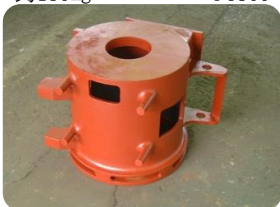
▪铁路零件 FCD400 约150kg FC300
